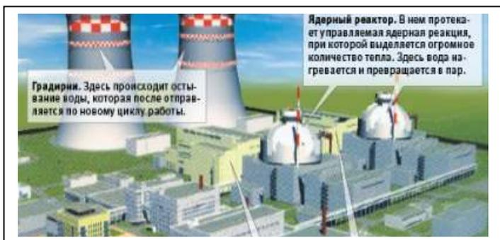
На АЭС энергия преобразуется из одного вида в другой: ядерная в тепловую, тепловая в механическую, механическая в электрическую.
