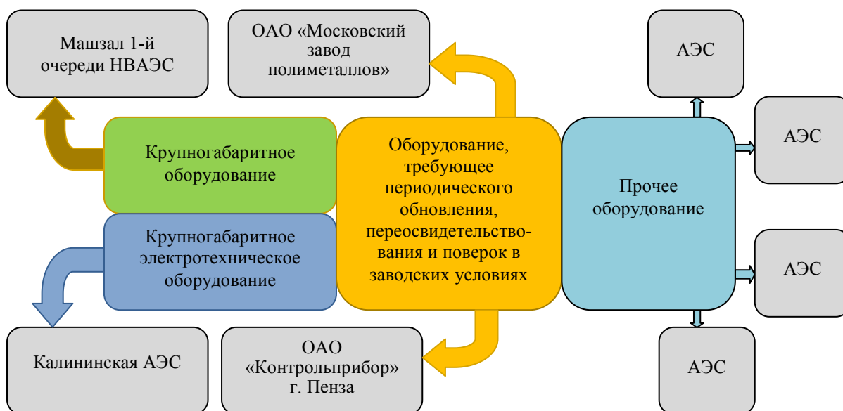
Рисунок – Базы хранения страхового запаса оборудования для АЭС
