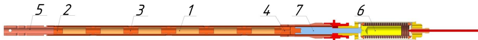
1 – трубчатый образец; 2 – концевая втулка; 3 – переходная втулка; 4 – упорная втулка; 5 – обойма; 6 – блок нагрузки; 7 – нагружающий шток
