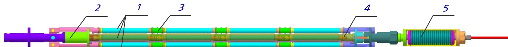
1 – трубчатые образцы; 2 – концевик; 3 – соединительная втулка; 4 – упорная втулка; 5 – блок нагрузки;
