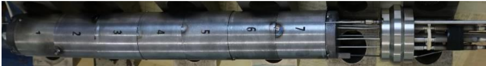
Фотография рабочего участка облучательного устройства ГЭКС-В (высокотемпературного) без корпуса ампулы
