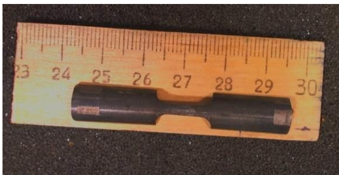
Фотография продольного сегментного образца, вырезанного из оболочки твэла до испытания
