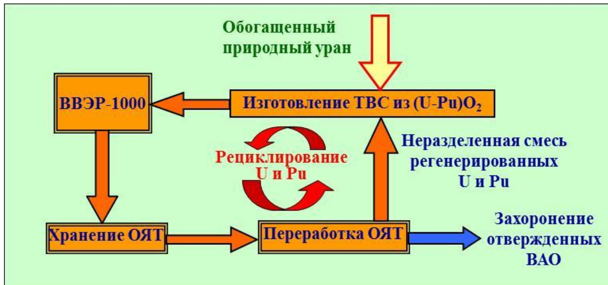
Схема многократного рециклирования регенерированных урана и плутония в виде РЕМИКС-топлива в реакторах ВВЭР-1000
