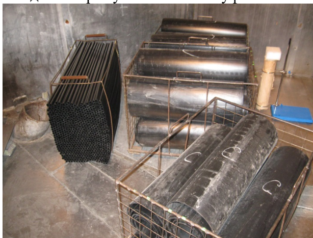
Рис. 13. Радиационная сшивка полиэтиленовых труб
